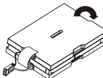
Рисунок 9. Порядок сборки комплекта из трех батарей.
