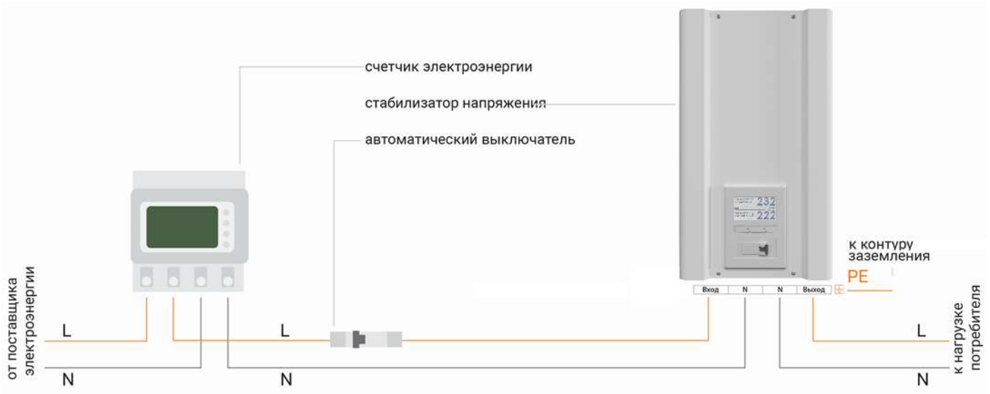
Рисунок 6. Схема подключения стабилизатора к однофазной сети
